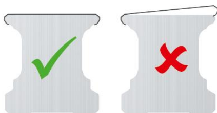
Obr. 5.45: Správně a nesprávně nasazený krycí pásek
