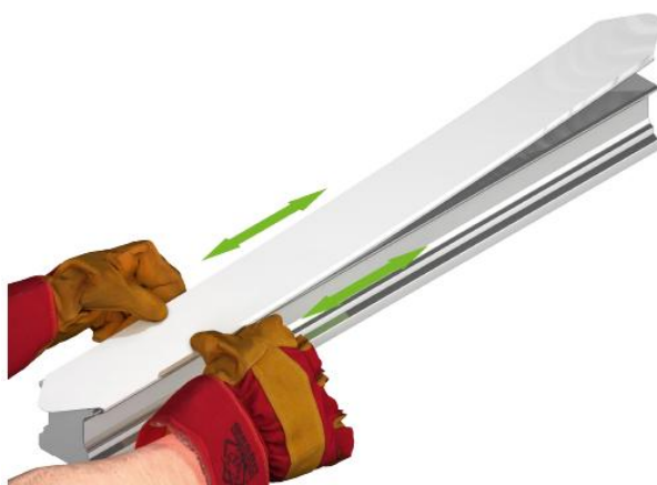
Obr. 5.27: Montáž krycího pásu
